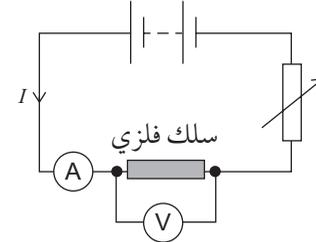
الكميات المقاسة والأدوات: قس كلاً من فرق الجهد الكهربائي (V) عبر السلك وشدة التيار الكهربائي (I) بداخله بالفولتميتر والأميتر على الترتيب.
